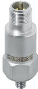
SIPLUS CMS2000 VIB-Sensor S01 Vibrationsaufnehmer; Frequenzbereich 0,5Hz bis 15kHz; Messbereich 50G; Empfindlichkeit 100mV/G (+/-10%); MIL-Stecker oben
