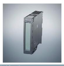
SIPLUS S7-1500 DQ 16x230VAC 1A ST TRIAC based on 6ES7522-5FH00-0AB0 mit Conformal Coating, -40...+70°C, start up -25°C, Digitalausgabemodul 16 Kanäle in Gruppen zu 2; 2A pro Gruppe; Ersatzwert
