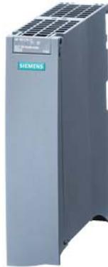
SIMATIC ET 200MP. PROFINET IO-Device Interface-Modul IM 155-5 PN HF, für ET 200MP Elektronikmodule; bis zu 12 IO-Module ohne PS; bis zu 30 IO-Module mit zusätzlicher PS; integrierter 2PORT-Switch; RJ45 Shared Device; MRP; IRT  $\geq 0,25\text{ms}$ ; Taktsynchronität FW-Update; I&M0...3; priorisierter Hochlauf, S2-Redundanz; Shared Device mit 4 Controllern Geeignet für den Betrieb mit dem Aktiven Rückwandbus (ab FW V4.4)
