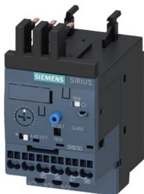
Überlastrelais 4...16 A elektronisch für Motorschutz Baugröße S00, CLASS 10E Schützenbau Hauptstromkreis: Federzugklemme Hilfsstromkreis: Federzugklemme Hand-Automatik-RESET
