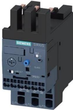
Überlastrelais 10...40 A elektronisch für Motorschutz Baugröße S0, CLASS 10E Schützenbau Hauptstromkreis: Federzugklemme Hilfsstromkreis: Federzugklemme Hand-Automatik-RESET
