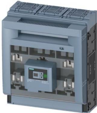
SENTRON, Sicherungslasttrennschalter 3NP1, 3-polig, NH3, 630 A, für Aufbau und Einbau auf Montageplatte, Rahmenklemme, Sicherungsüberwachung: elektronisch EFM20, Abdeckebene 70mm
