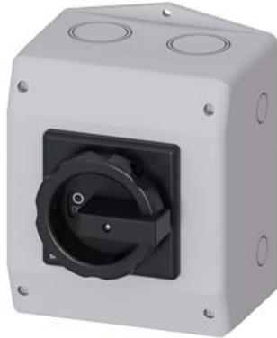
SETRON, Lasttrennschalter 3LD, DC-Schalter, 2-polig, Iu: 32 A, Betriebsstrom / bei DC- 21 A bei 800V: 32 A, Isolierstoff-Kapselung für metrische Verschraubung, Drehantrieb, schwarz
