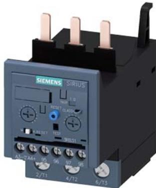
Überlastrelais 12,5...50 A elektronisch für Motorschutz Baugröße S2, CLASS 5E...30E Schützenbau Hauptstromkreis: Schraub Hilfsstromkreis: Schraub Hand-Automatik-RESET interne Erdschlusserkennung
