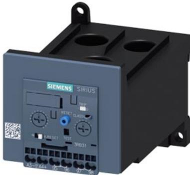
Überlastrelais 12,5...50 A elektronisch für Motorschutz Baugröße S3, CLASS 5E...30E Einzelaufstellung Hauptstromkreis: Durchsteckw. Hilfsstromkreis: Federzugklemme Hand-Automatik-RESET
