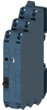
Trennwandler mit H-A-Schalter AC/DC 24 V, 3-Wege-Trennung Eingang: 0-10 V, 0/4-20 mA Ausgang: 0-10 V, 0/4-20 mA Federzuganschluss (Push-In)
