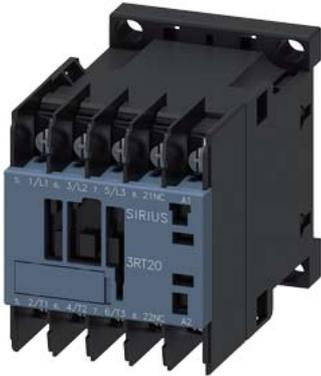
Leistungsschütz, AC-3 12 A, 5,5 kW / 400 V 1 Ö, AC 200 V, 50 Hz 200-220 V, 60 Hz, 3-polig Baugröße S00 Ringkabelschuhanschluss
