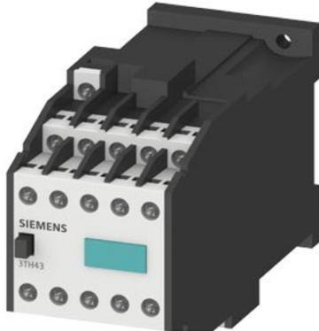
Hilfsschütz, 73E, DIN EN 50011, 7 NO + 3 NC 1U Schraubanschluss DC-Betätigung, DC 24V
