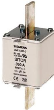
SITOR-Sicherungseinsatz, mit Messerkontakten, NH2, In: 400 A, gR, Un AC: 690 V, Un DC: 250 V, Stirnkennmelder
