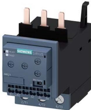
Überwachungsrelais, anbaubar an Schütz 3RT2, Baugröße S2 Basic, analog einstellbar Scheinstromüberwachung 8...80 A, 50...60 Hz, 2-phasig Versorgung 24-240 V AC/DC 1 Wechsler Überwachung auf Stromüber- und Unterschreitung Phasenausfall, Drahtbruch mit oder ohne Fehlerspeicher Anlaufverzögerung 0-60 s Störspitzenausblendung 0-30 s Schalthysterese 6% Federzugtechnik
