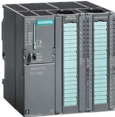
SIMATIC S7-300, CPU 313C, Kompakt-CPU mit MPI, 24 DE/16 DA, 4AE, 2AA, 1 Pt100, 3 schnelle Zähler (30 kHz), integr. Stromversorgung DC 24V, Arbeitsspeicher 128 KByte, Frontstecker (2x 40-polig) und Micro Memory Card erforderlich
