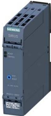
Thermistor-Motorschutzrelais Standard-Auswertegerät 22,5 mm Gehäuse Federzugklemme 2 Wechsler bistabil US = AC/DC 24 V-240 V Hand/Auto/Fern-RESET 2 LEDs (READY/TRIPPED) galvanische Trennung Test-/RESET-Taste Drahtbruchüberwachung Kurzschlussüberwachung nullspannungssicher
