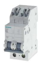
Leitungsschutzschalter 230V 6kA, 1+N-polig, C, 10A, T=70mm mit schraubenlosen Abgangsklemmen
