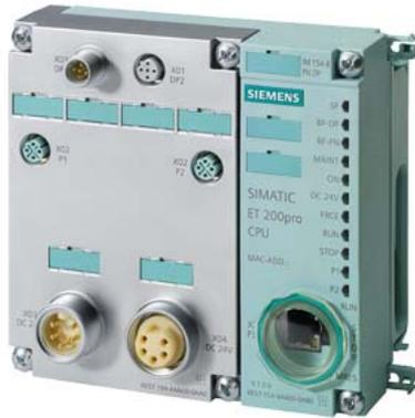
SIMATIC DP, IM154-8 PN/DP CPU f. ET200 PRO, 384KB Arbeitsspeicher, int. PROFINET-Schnittstelle, int.PROFIBUS-DP Master/Slave SS Schutzart IP65/67, Micro Memory Card und Anschlussmodul erforderlich
