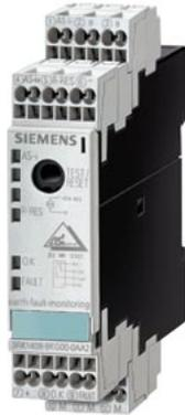
AS-i Erdschlussmodul IP20 S22,5, Erdschlussüberwachung 1 Eingang, Remote Reset 2 x Meldeausgang, Relais DC-12 1 A / DC-13 500 mA (24 V) Federzugklemme Baubreite 22,5 mm keine AS-i Adresse notwendig nur AS-Interface Überwachung
