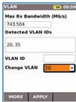
Detección Automática de las ID de VLAN permite al usuario configurar el Navitek NT para operar en la VLAN que desee (realizar Ping, Mapa de red, Traza de ruta IP, etc.)
