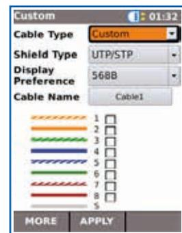
Utilice una amplia lista de mapeados de Hilo seleccionables para cables Ethernet típicos y cables no-Ethernet tales como Profinet, ISDN y otros.
