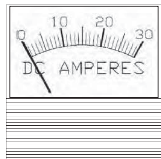
Fig. 15 Amperímetro (Medidor de amperios)
