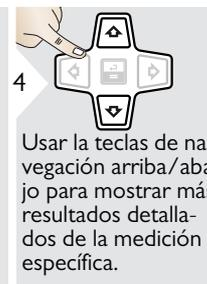
Usar la teclas de navegación arriba/abajo para mostrar más resultados detallados de la medición específica.
