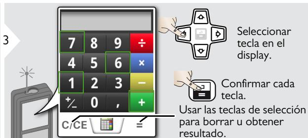
**i** El resultado de medición de la línea principal se transfiere a la calculadora y puede usarse para otros cálculos. Ft/in fraccional se convierte en ft/in decimal.
