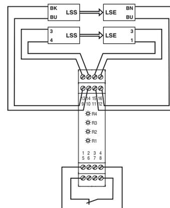
Ejemplo de conexión Módulotarjeta sensor de 4 canales
