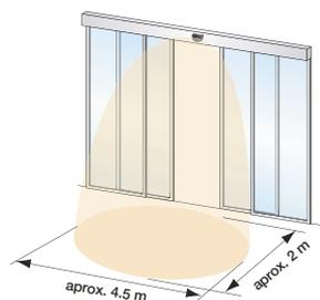
Altura de montaje 2.200 mm/Ángulo del campo de detección 30°
