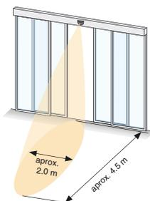
Altura de montaje 2.200 mm/Ángulo del campo de detección 30°
