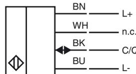
**Conexión eléctrica receptor**
