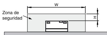
Durante el funcionamiento no deben manipularse objetos metálicos en las inmediaciones de la zona de seguridad.
