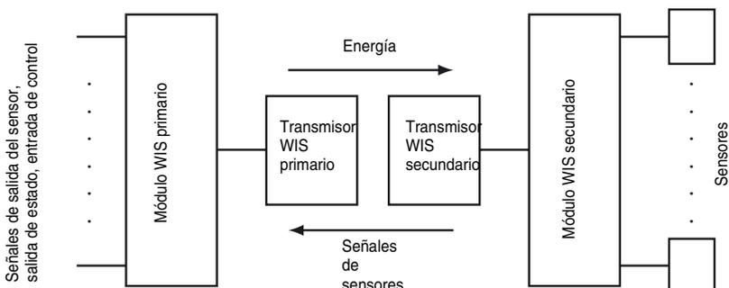
La suma de las corrientes de reposo de todos los sensores conectados al módulo WIS secundario no puede ser mayor que la corriente máxima que se puede transmitir. Ésta es igual a la potencia transmisible indicada por los transmisores / 12 V.
