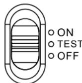
Una vez establecida la alimentación eléctrica (con cable o pilas) e introducida la tarjeta de memoria SD\*, la cámara de observación está lista para funcionar. Encienda la cámara con el interruptor ON/TEST/OFF (11), al que puede acceder cuando el cuerpo de la cámara está abierto.
