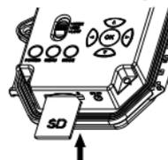
Necesitará una tarjeta de memoria SD\* (mínimo 8 MB, máximo 32 GB) para poder guardar imágenes o vídeos. Insértela en la ranura para tarjetas SD (13) hasta que encaje en su sitio con un ligero clic. Para extraerla, presione sobre la tarjeta estando introducida. La tarjeta saldrá un poco de la ranura, haciendo un ligero clic, para que se pueda extraer totalmente.
