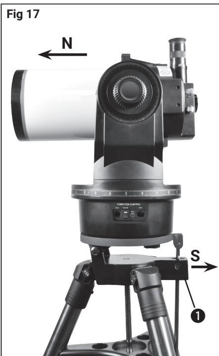
Alineación altazimutal: La base basculante y el tubo son horizontales. La abertura del tubo mira hacia el norte (N)
