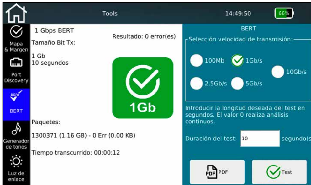
Figura 37 – Prueba BERT individual
