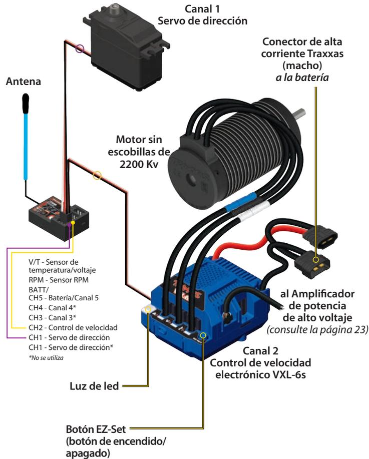
**Diagrama de cableado del motor/ESC**
