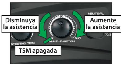
**Nota:** La TSM se desactiva automáticamente cuando se conduce o frena marcha atrás.
