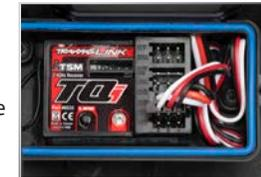
**Nota:** Para obtener un mejor rendimiento, se recomienda que se instale este receptor en la orientación original como se muestra.
