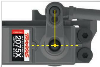
8. Verifique el funcionamiento del servo; para ello, gire la rueda de dirección hacia un lado y otro para garantizar que el mecanismo esté bien centrado y que haya igual recorrido en ambas direcciones. Utilice la perilla de nivel de la dirección del transmisor para ajustar con precisión la posición de la bocina del servo de manera tal que el modelo se dirija en línea recta cuando la rueda de dirección está en neutral.
