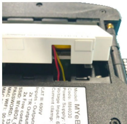
Figura 5: Inserción de la batería.
