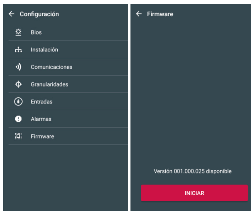
Figura 26: Pantalla de actualización del firmware del MYeBOX.
