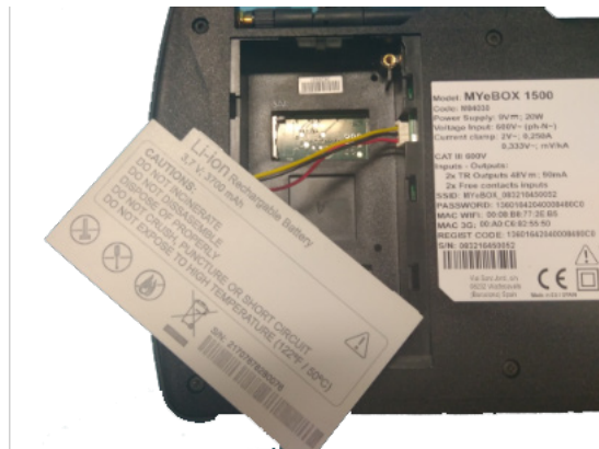
Figura 3: Conectar la batería.
