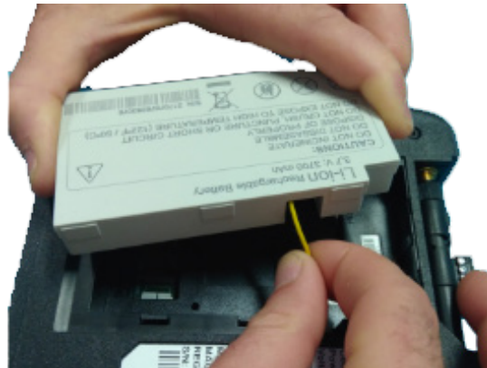
Figura 4: Introducir el cable de conexión en el interior de la envoltura de la batería.
