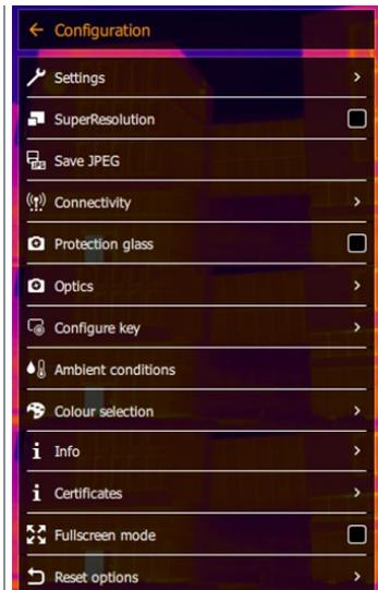
1,3 Seleccionar Configurar tecla [Configure key] (joystick o pantalla táctil).
