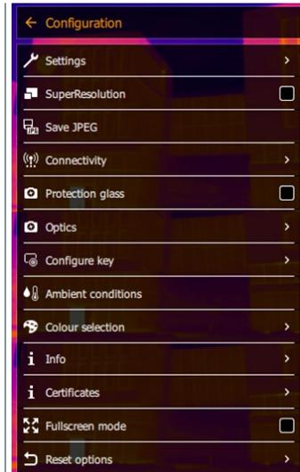
3 Seleccionar **Condiciones ambientales [Ambient conditions]** (joystick o pantalla táctil).
