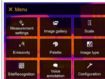
2 Seleccionar **Ajustes de medición [Measurement settings]** (joystick o pantalla táctil).
