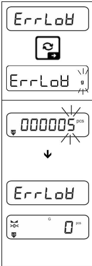
⇒ Mediante las teclas de navegación  $\uparrow\downarrow$ , elija el ajuste < ErrLoB > y valide mediante el botón  $\rightarrow$ .
