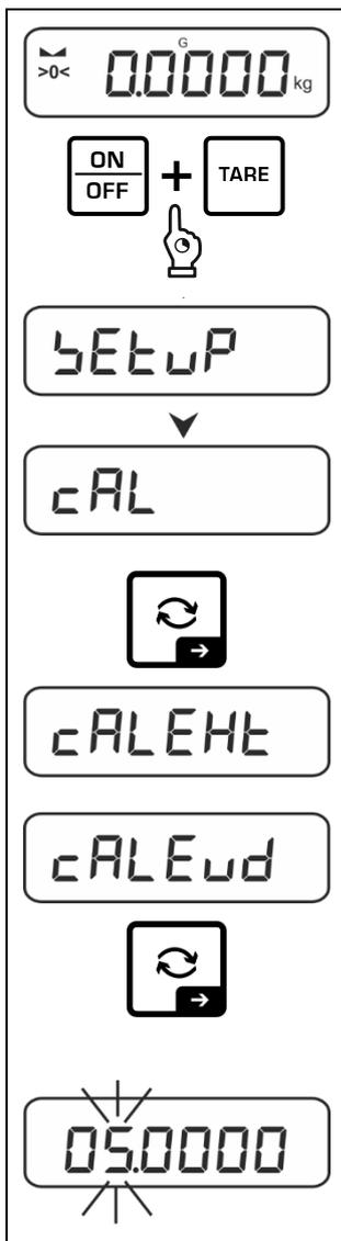
⇒ Para acceder al menú de configuración, mantenga presionados simultáneamente los botones **TARE** y **ON/OFF**.
