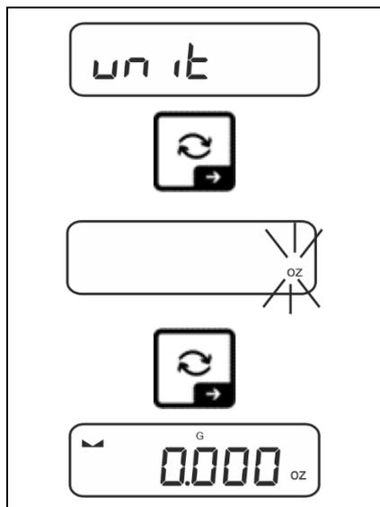
⇒ Seleccione la configuración del menú < un it > y confirme mediante el botón →.
