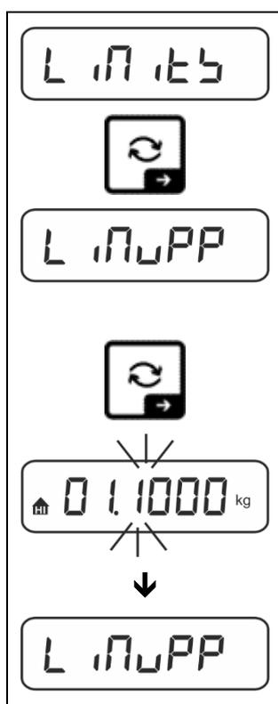
⇒ Mediante los botones de navegación ↑↓, elija el ajuste < L i n i t s > y valide mediante el botón →.
