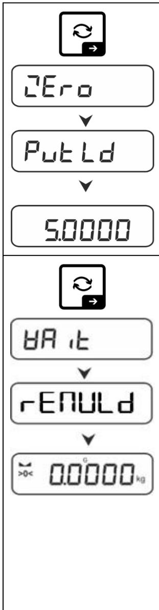
⇒ Valide la selección mediante el botón →. <Zero>, Aparecerán seguidamente las indicaciones <Zero> y <Put Ld> y, a continuación, aparecerá el valor de masa de la pesa de ajuste que se ha de colocar sobre el plato.
