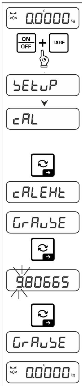
⇒ Para acceder al menú de configuración, mantenga presionados simultáneamente los botones **TARE** y **ON/OFF**.
