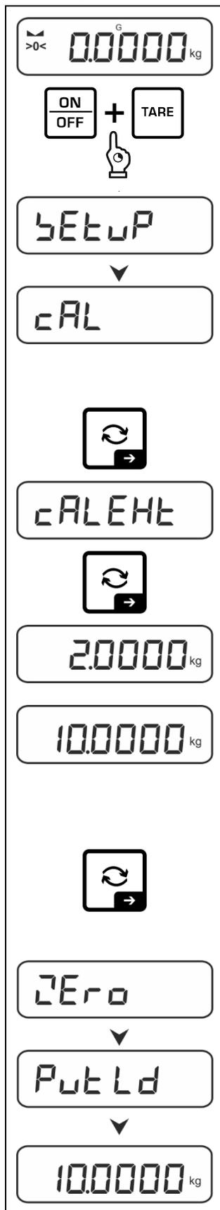
⇒ Para acceder al menú de configuración, mantenga presionados simultáneamente los botones **TARE** y **ON/OFF**.
