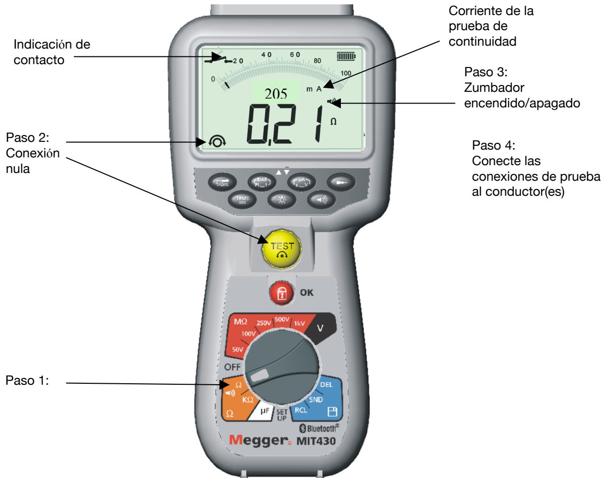
Figura 9: Prueba de continuidad y zumbador
