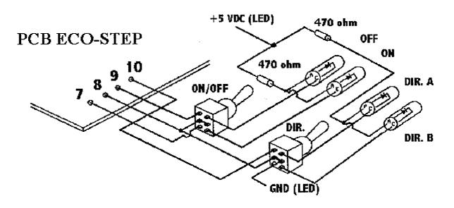
Ce sont des interrupteurs bipolaires. Vous pouvez utiliser un pôle pour la commande et l'autre pour allumer une led indiquant l'état du moteur.Le potentiomètre RV1 permet de modifier la
