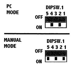
Pour choisir entre le mode manuel et le mode PC, il faut ajuster les états du DIP SWITCH 5 contacts (DIPSW.1)
