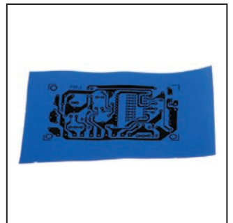
4 - Il est préférable de laisser quelques centimètres de marge de chaque côté du circuit imprimé.
