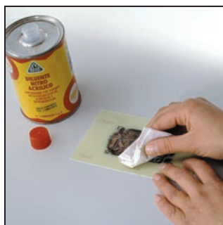
11 - Nettoyez ensuite le circuit imprimé avec un diluant nitré de façon à faire disparaître la couche.
