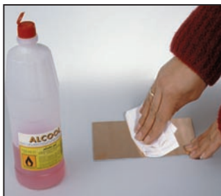
5 - Nettoyez soigneusement le cuivre du circuit avec de l'alcool de façon à ce qu'il soit brillant et non gras.
