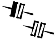
Le LCR Atlas utilise deux méthodes différentes pour analyser les condensateurs, l'analyse de l'impédance AC pour les condensateurs de faible valeur (inférieure à 1  $\mu\text{F}$ ) et l'analyse de charge DC pour des condensateurs plus larges (env. 1  $\mu\text{F}$  à 10 000  $\mu\text{F}$ ).
