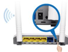
Pressez la touche WPS de votre routeur et la touche WLAN de l'enceinte simultanément. La LED de l'enceinte affiche un clignotement rapide. Après 10 à 40 secondes, la LED sur l'enceinte passe en blanc permanent: **L'enceinte est connectée à votre réseau.**
