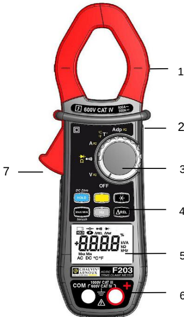
Figure 1 : la pince multimètre F203
