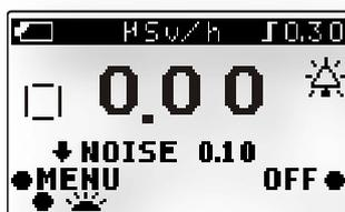
Le passage du mode « FOND » au mode « MESURE » se fait dans la section « BACKGROUND » du mode « MENU » (page 22) par la disposition du pictogramme
