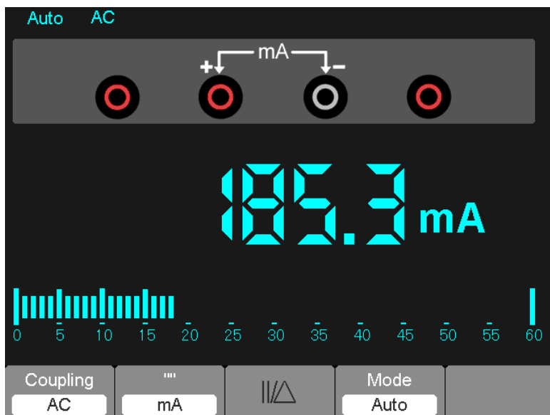
Schéma 7-10 Mesure du courant AC pour 600 mA
