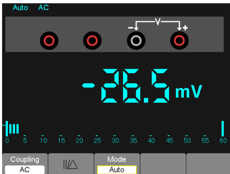
Schéma 7-7 Mesure de la tension AC
