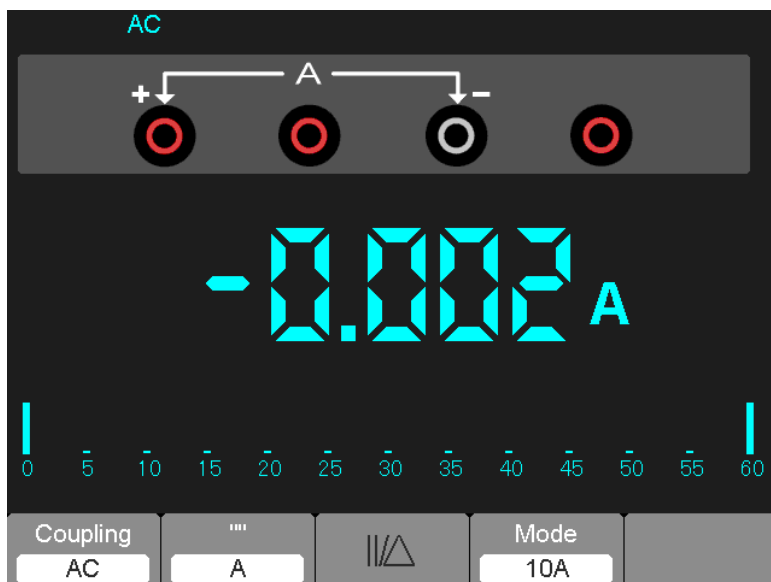
Schéma 7-11 Mesure du courant AC de 10 A
