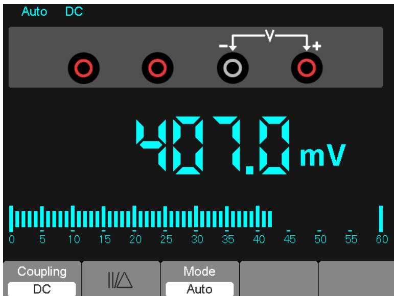
Schéma 7-6 Mesure de la tension DC
