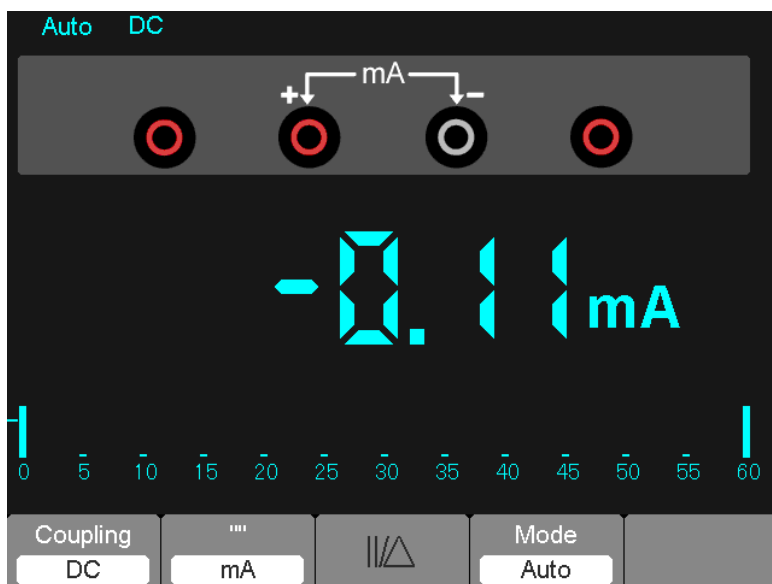
Schéma 7-8 Mesure du courant DC de 600 mA
