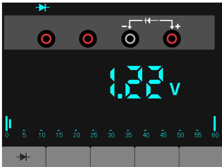
Schéma 7-3 Mesure de diode
