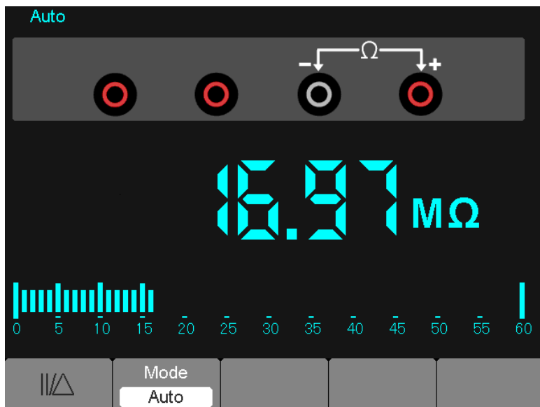
Schéma 7-2 Mesure de la résistance
