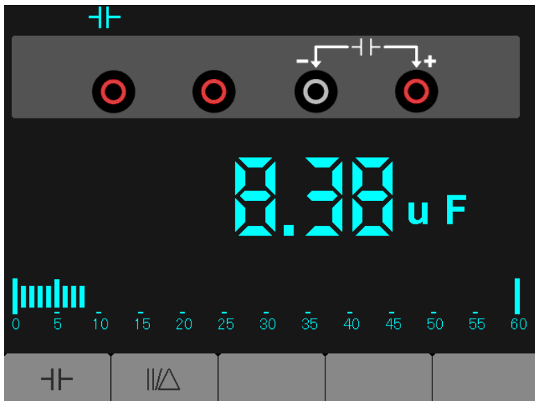
Schéma 7-5 Mesure de la capacité
