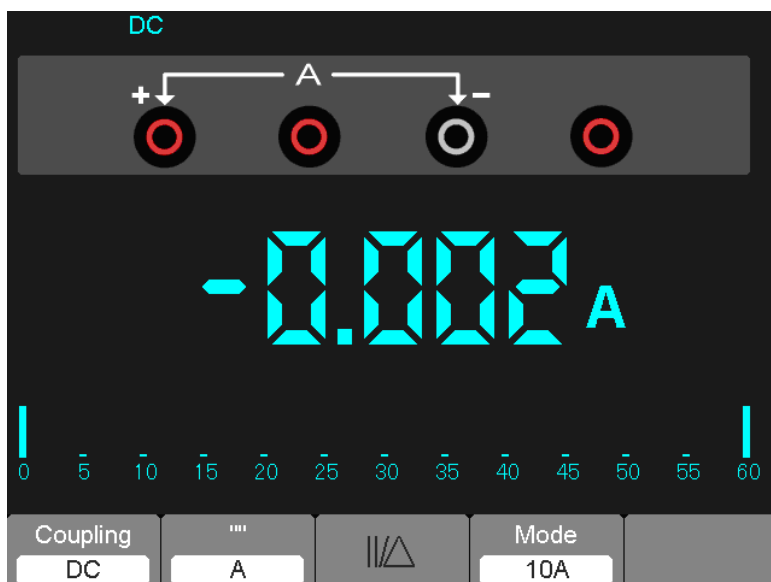
Schéma 7-9 Mesure du courant DC de 10 A
