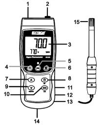
**Remarques :** Les éléments 11 à 13 se trouvent derrière le couvercle détachable du compartiment situé sur le côté droit de l'appareil.
