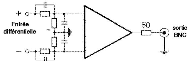
Principe d'une sonde différentielle
