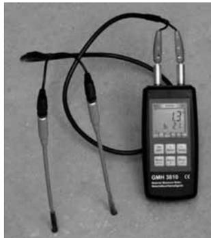
Mesure du béton avec sondes GBSL91
