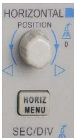
**1. Bouton de POSITION HORIZONTALE:** Sert à contrôler la position du déclenchement par rapport au centre de l'écran. Appuyez sur ce bouton pour rétablir le point du déclenchement au centre de l'écran.
