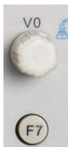
V0: Molette multifonction Sous différentes options de menu, il supporte la sélection d'options de menu (MESURE), le déplacement des curseurs et niveaux (Déclenchement Pente).
