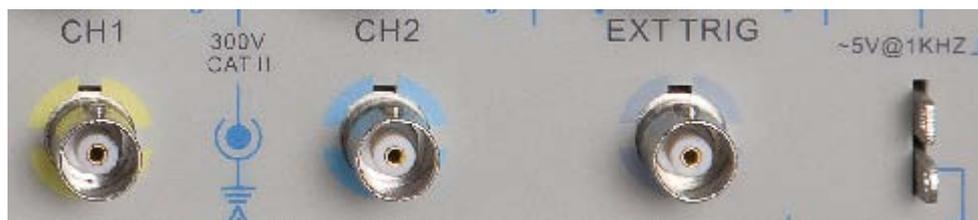
1. CH1, CH2: Connecteurs d'entrée pour affichage d'oscillogramme, à travers est connecté et entre le signal à mesurer.
