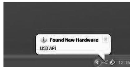
1. Insérez l'enregistreur de données USB dans le port USB de votre ordinateur. Les écrans suivants apparaîtront automatiquement. Windows™ XP se réfère aux enregistreurs de données tel que "USB API" et "F32x Express USB Device" pendant cette installation.
