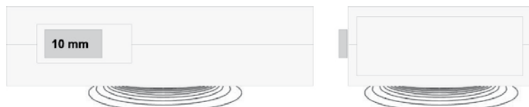
Vue de côté : champ de mesure et profondeur de pénétration lors d'un réglage «10 mm»
