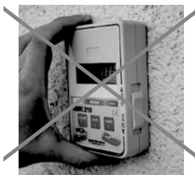
Incorrect : surface irrégulière
