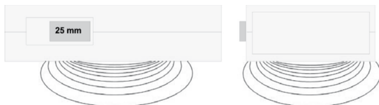
Vue de côté : champ de mesure et profondeur de pénétration lors d'un réglage «25 mm»
