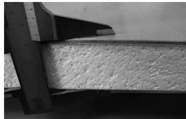
Exemple «nid d'abeilles» : aluminium – isolation- contreplaqué
