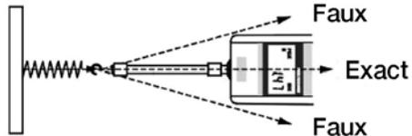
Ne chargez jamais l'appareil de mesure au dessus de la charge maximale indiquée (risque de cassure!!).
