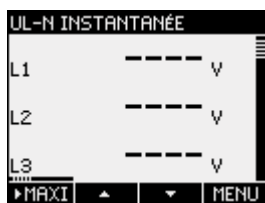
Figure 3-2 Affichage de la tension de mesure pour le Mode de raccordement 3P3W
