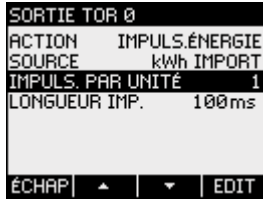
Figure 3-8 Sortie à impulsions
