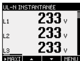
Figure 3-1 Affichage de la tension de mesure pour le Mode de raccordement 3P4W
