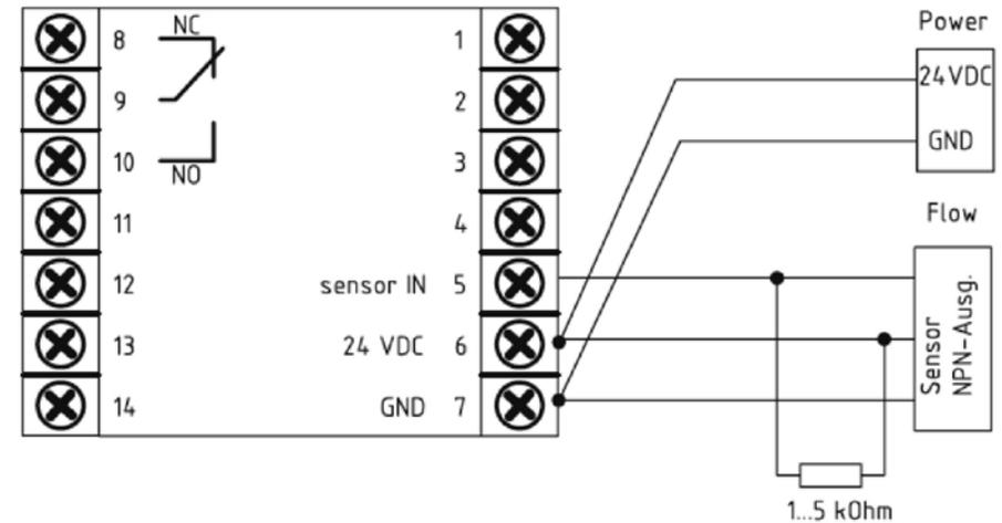
Capteurs de débit avec sortie à collecteur ouvert et pull up intégré, type PNP
